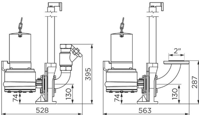
Posizionamento con anello di supporto a pavimento
