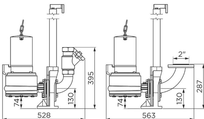
Instalação com anel de suporte de piso
