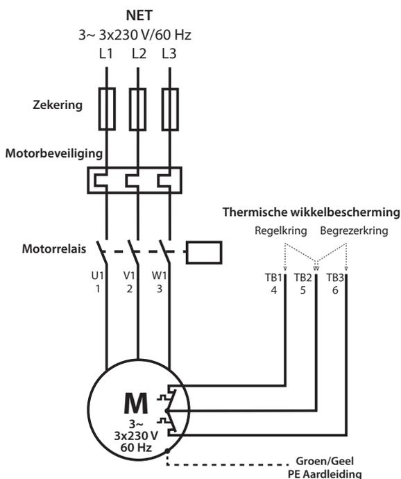
Aansluiting van de thermische wikkelbeveiliging:
