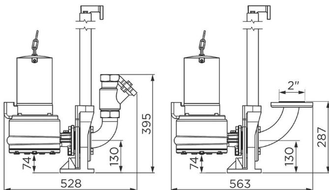
Mise en place avec couronne d'appui au sol
